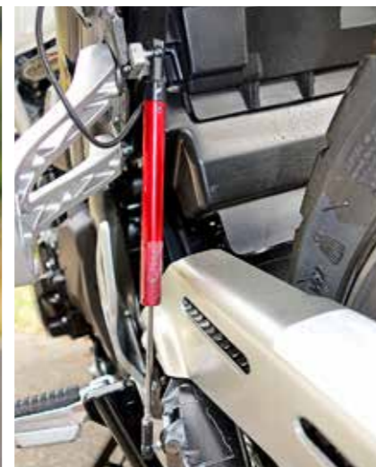
Kurz fällt die Tragfeder, dick die Kolbenstange des Nivomat-Dämpfers aus. Im Vergleich zu herkömmlichen Federbeinen ist er um 180 Grad gedreht montiert. Per Federwegsensoren wurde der Hub des Dämpfers auf den Teststrecken ermittelt
