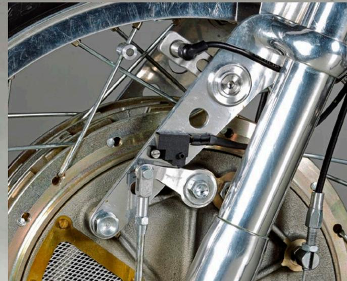
Clever: Mit Waagebalken an den Bremszügen verzögern die Bremsbeläge auf beiden Seiten synchron und gut dosierbar
